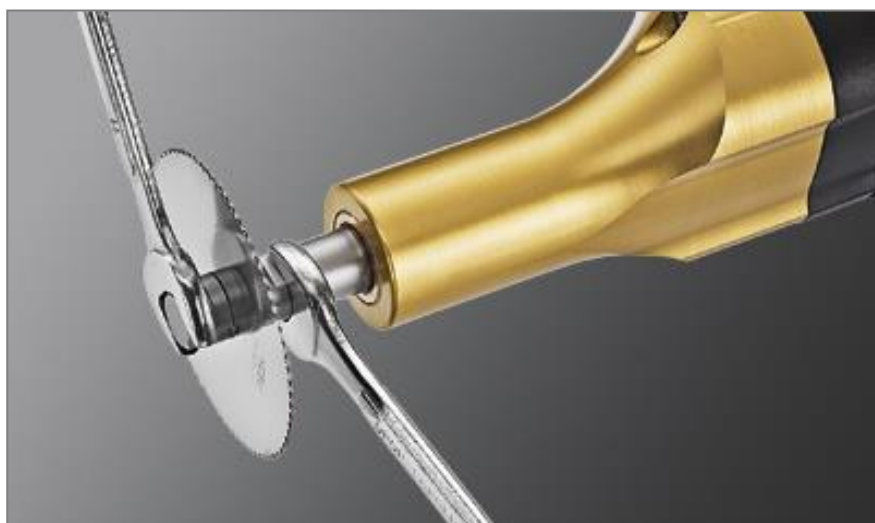
Fig. 1: Desserrer la vis de maintien
