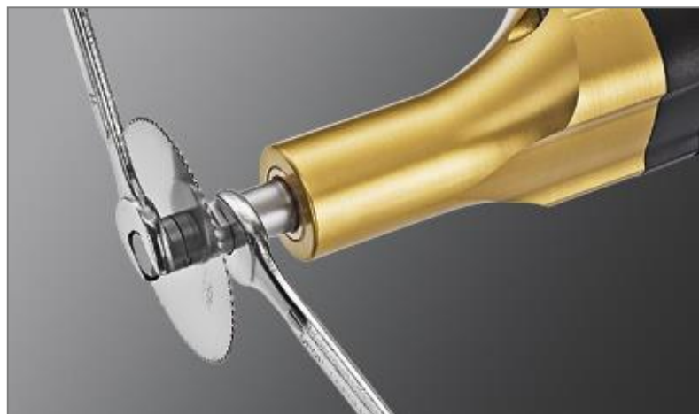
Abbildung 1: Lösen der Halteschraube
